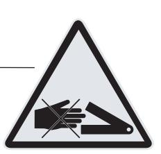
Tenga cuidado al cambiar la posición o abatir los apoyos anti-vuelco, especialmente si los ajusta o acciona con la mano. Entre la barra de sujeción [95] y la pieza de apriete [94] tiene que actuar una fuerza elástica elevada y, por tanto, existe peligro de aplastamiento.
