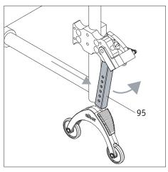
• Cuando haya instalado las ruedas puede devolver los apoyos anti-vuelco a su posición inicial. Para ello empuje la silla de ruedas hacia delante y, al mismo tiempo, la barra de sujeción [95] hacia atrás con el pie.
