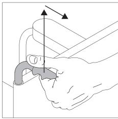
• Al mismo tiempo, tire levemente de la silla hacia arriba y hacia atrás agarrándola por sus empuñaduras hasta que los apoyos anti-vuelco queden encajados en una posición fija.
