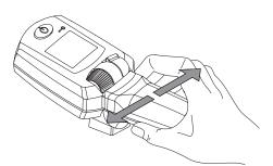
El sistema electrónico situado en la empuñadura registra los movimientos que parten de la mano del operador. Una ligera presión de la palanca hacia la izquierda o la derecha se convierte en una orden de marcha para las ruedas Esprit, lo cual permite recorrer curvas sin mayores esfuerzos.
