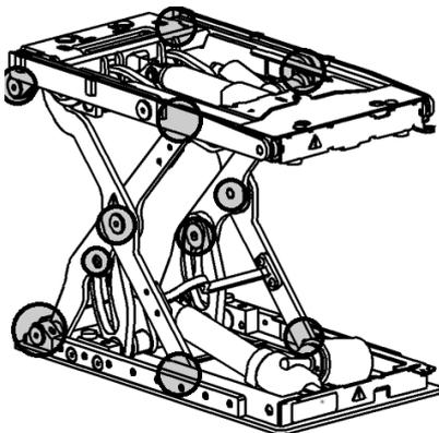
Fig. 4-1 Lifter module
