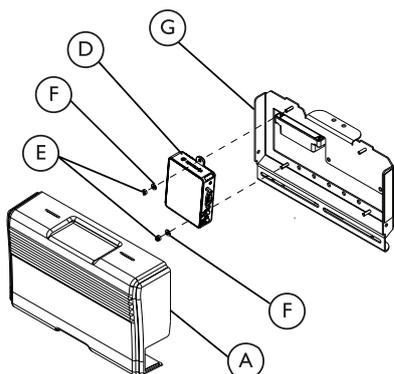
Fig. 15-1 Input Module Replacement—Manual Backrest
