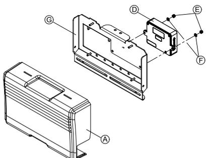
Fig. 15-5 Actuator Module Replacement—Manual Backrest
