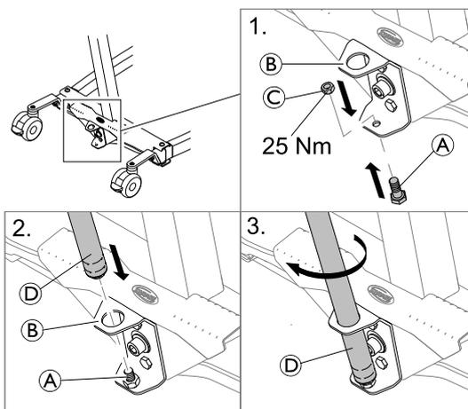
1. Insérez le boulon © par le dessous dans le trou inférieur du support © et fixez-le avec l'écrou ©.
