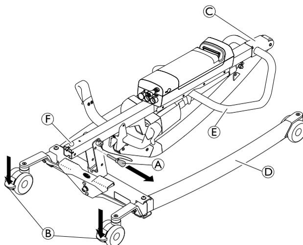
1. Verrouillez les deux roulettes arrière ②. Retirez la goupille de verrouillage ①.
