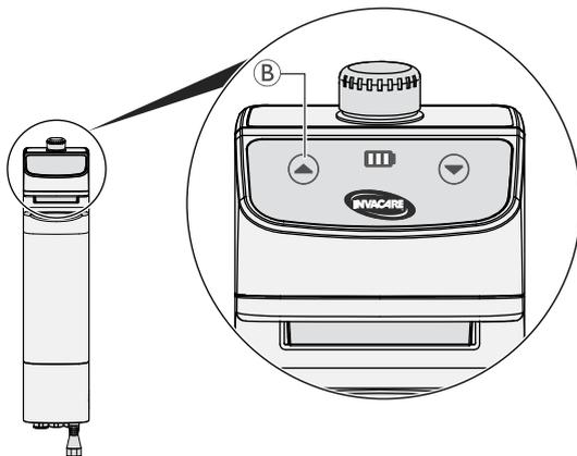
1. Pour élever la flèche, appuyez sur le bouton **B** à l'avant du **boîtier de contrôle** et maintenez-le enfoncé.
