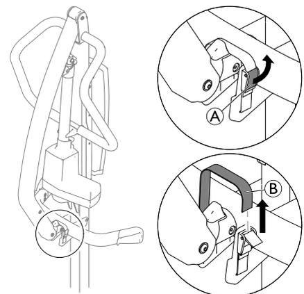
Ouvrez le dispositif de fixation ① et retirez la bande ② de la boucle de serrage.
