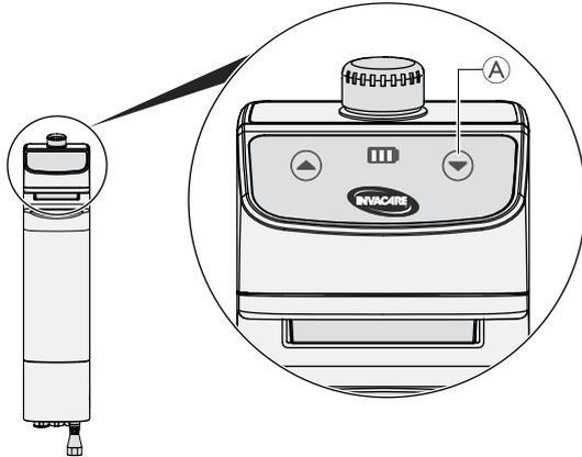
1. Pour abaisser la flèche, appuyez sur le bouton **A** à l'avant du **boîtier de contrôle** et maintenez-le enfoncé.
