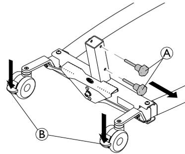
Verrouillez les deux roulettes arrière ② et faites pivoter les vis à molette ① dans le sens inverse des aiguilles d'une montre pour les retirer de la base
