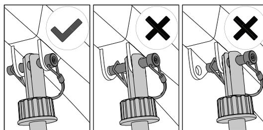
Alignez les trous et réinstallez la broche ©. Assurez-vous que la broche est complètement insérée et fixez-la au moyen de D-clip.
