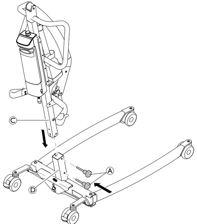
La flèche étant orientée vers l'avant, abaissez le mât ③ dans le support de la base ④ et remettez les vis à molette ① en place pour fixer le mât ③ à la base.
