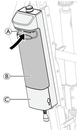
2. Soulevez la batterie pour la retirer du boîtier de contrôle **C** ou de la base du chargeur **D**.
