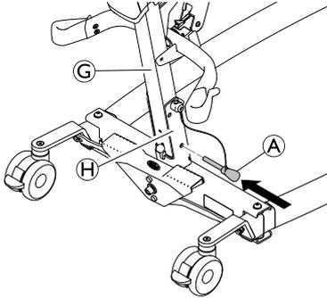
Réintroduisez la goupille de verrouillage ① dans le mât ③ et dans la base ④. Assurez-vous que la goupille de verrouillage est correctement insérée.
