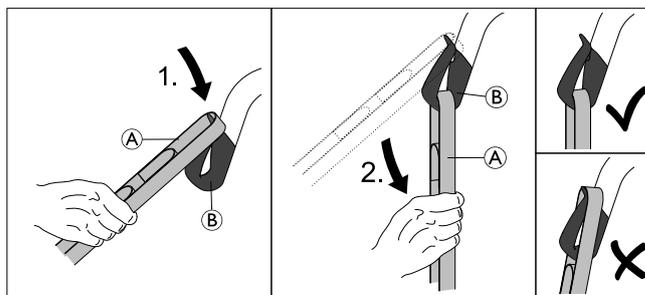
1. Placez la boucle de bande souhaitée **A** sur l'extrémité du crochet **B**.
