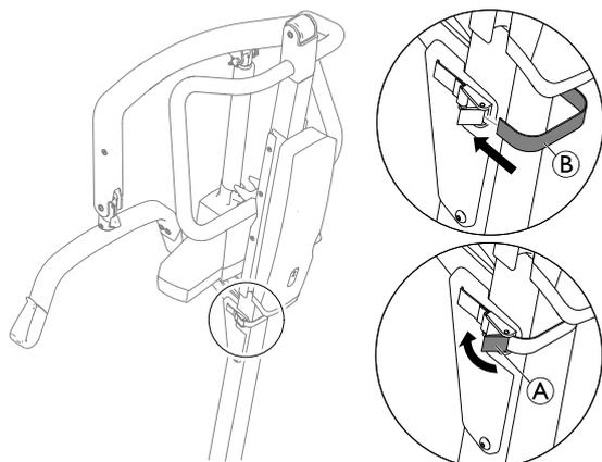
Enroulez la bande © autour de la partie arrière du mât, insérez-la dans la boucle de serrage et fermez le dispositif de fixation ©.
