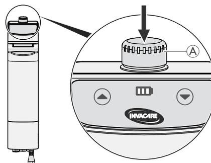
1. Appuyez sur le bouton d'arrêt d'urgence **ROUGE** **A** du boîtier de contrôle pour arrêter l'élévation ou la descente de la flèche et du patient.
