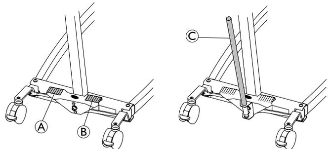
Le système manuel d'écartement des pieds est actionné par deux pédales (A) et (B) ou par le levier C.
